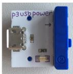
Die Stromversorgung wird benötigt, um die Signalgeneratoren zu betreiben.
