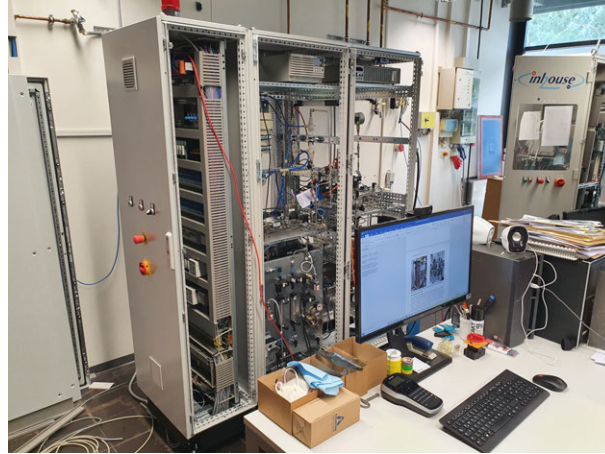
Abbildung 3.18: Teststand für die Untersuchung des URFC-Stacks
